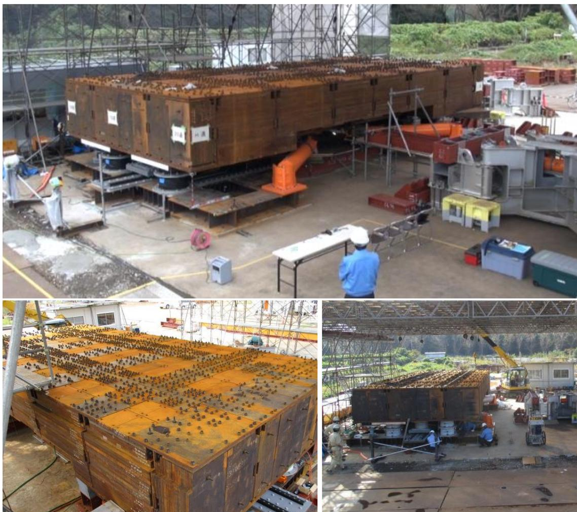
「デュアル TMD-NT」確認試験の様子
