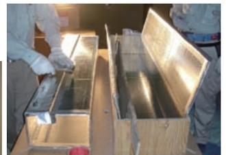
平板の状態で運搬し、使用場所で簡単に組み立てられます
