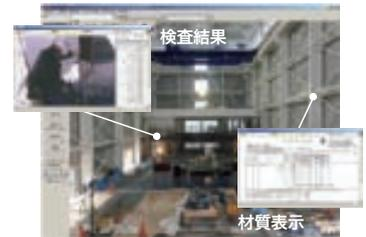
写真2 実際の工事写真に設計データや検査データを重ね合わせることでわかりやすいインターフェイスとなる
