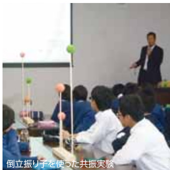
倒立振り子を使った共振実験
