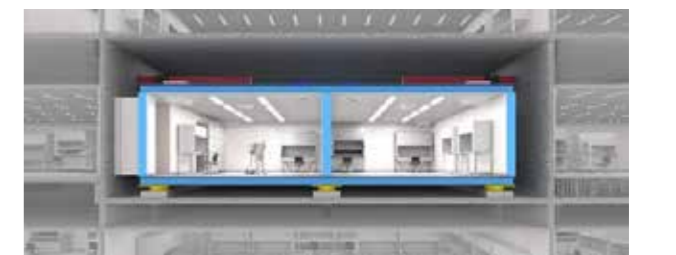
部屋免震システム
