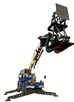
開発中の橋梁耐震補強用鋼製ブラケット取付ロボット
