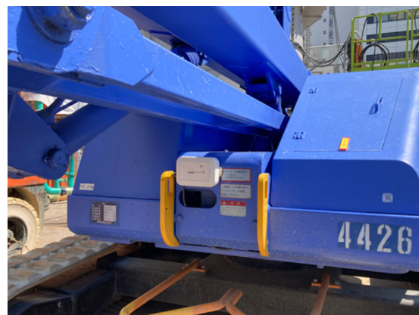
建設機械にIoTデバイスを装着しCO 2 排出量モニタリングを自動化
