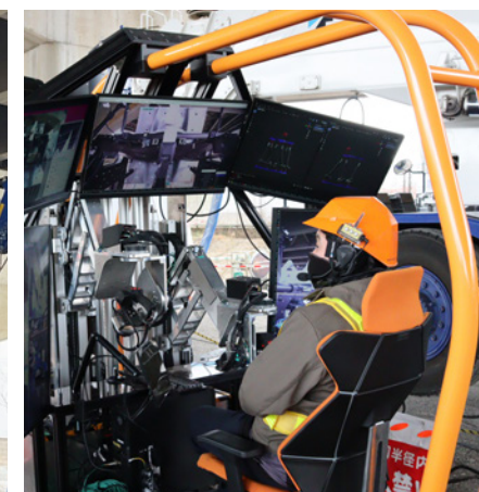
取り付け作業は遠隔操作機からモニターを見ながら、繊細で敏感な操作が可能
