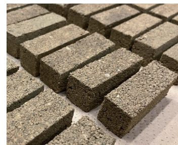
建設発生土を主原料とした環境配慮型建材
