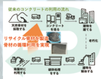
骨材（砂・砂利・碎石・砕砂）を循環利用サーキュラーコンクリート®②。
