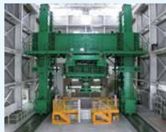
載荷能力30MNの世界最大級を誇る耐火実験装置。
