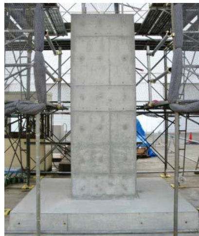
今回開発した ECM セメントを用いた構造体
