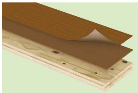
マンションフローリング材の下地
