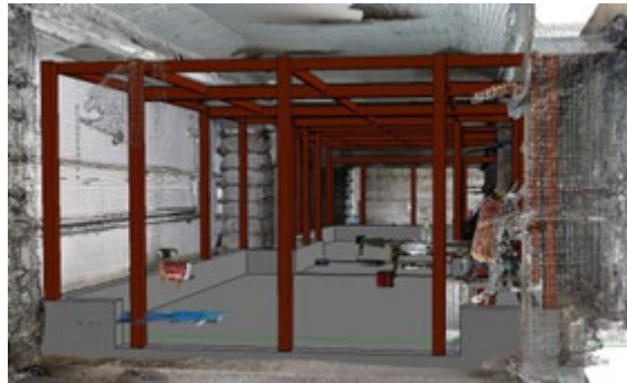
実測図（点群データ）と設計図（BIM データ）の照合
