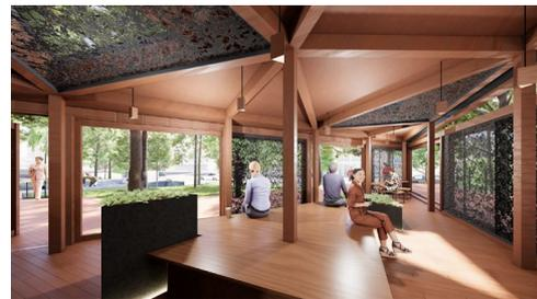
に、木立のような木造軸組、木製サッシによる大開口、植物のパターンをイメージした網戸、伐採した樹木を利用した照明器具、既存樹木の葉を転写したタイル、地面と直接つながる室内プランター等、様々な工夫を凝らしています。
