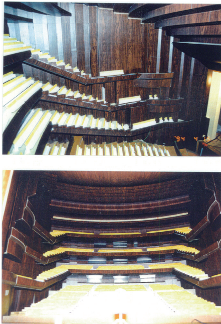
Photo 9 オペラ劇場の音響実験用1/10縮尺模型 1/10 scale model of opera theater for acoustical experiment
