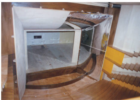
Photo 8 プロセニアムの周囲に構成した音響トランペット構造の初期の模型実験 An early scale model test for the acoustical trumpet constructed around the proscenium
