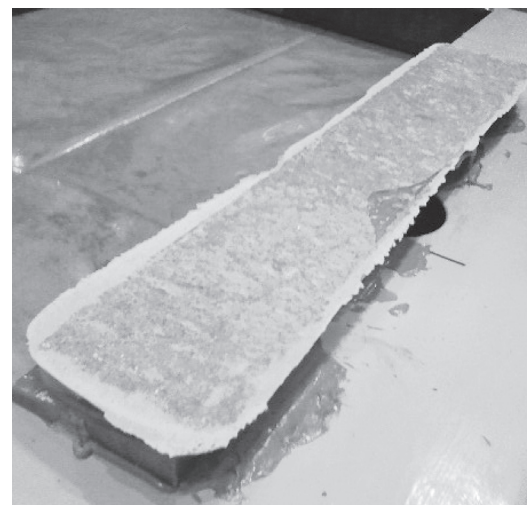
Photo 4 剥離後のくさびの状況 Detached wedge chip
