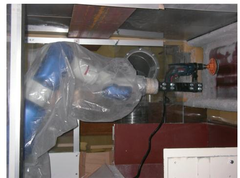
Photo 2 剥離ロボットの作業状況
