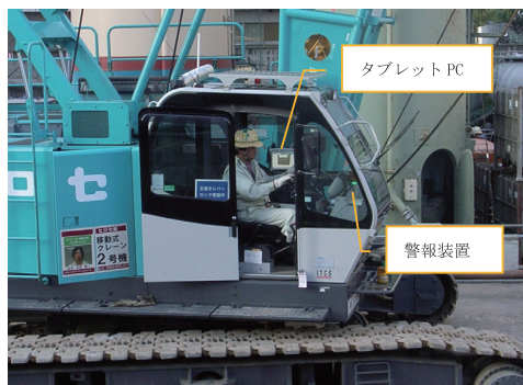
Fig.16 クレーン操作状況 Situation of crane operation
