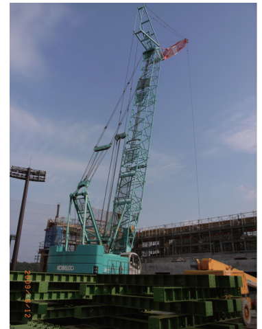
Photo 3 クローラークレーンタワーフロント仕様 Crawler crane with tower boom and luffing jib
