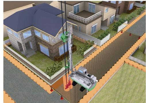
Fig. 1 スマートコラム工法の適用例
