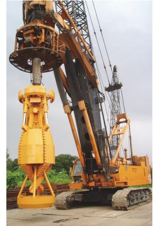
Fig. 2 多段拡径杭の施工機械
