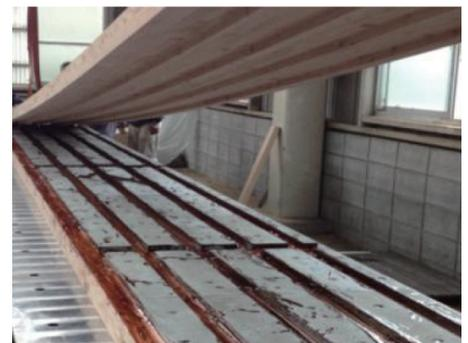
Photo 1 燃え代層・燃え止まり層の接着状況
