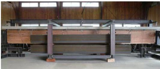
Photo 10 合成梁の曲げクリープ実験
