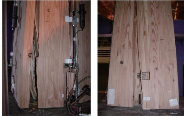
Photo 3 最終破壊状況
