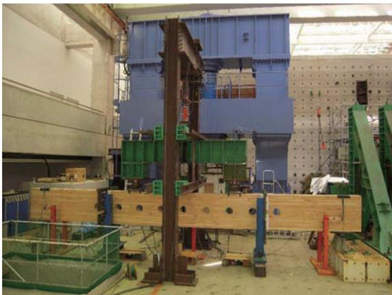
Photo 6 有孔梁の曲げ載荷実験
