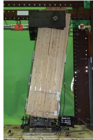
Photo 12 接合部の曲げ載荷実験
