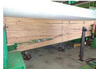
Photo 9 合成梁の破壊状況
