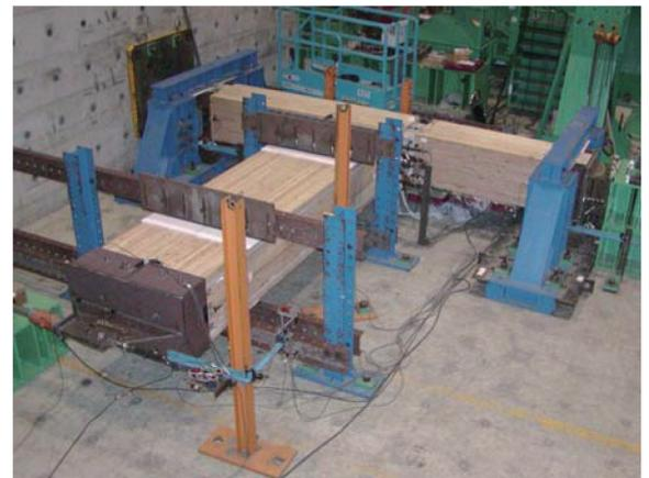
Photo 11 接合部の曲げ載荷実験
