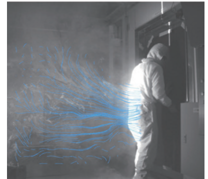
Fig. 16 扉通過時の人の動きに伴う気流の様子 Airflow influences by person's walking motion
