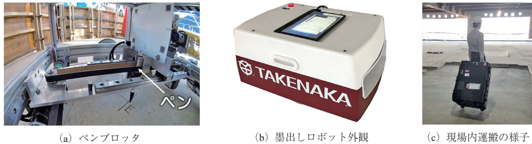
Fig. 10 小型・軽量の墨出しロボット Small and lightweight marking robot
