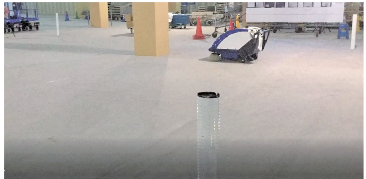
Photo 12 清掃指定エリア内での障害物回避機能 Verification of obstacle avoidance function in the sweeping area
