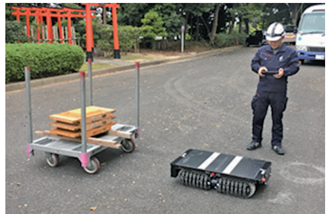
Photo 5 建設現場用台車と「クローラTO」 Construction site cart and “Crawler TO”
