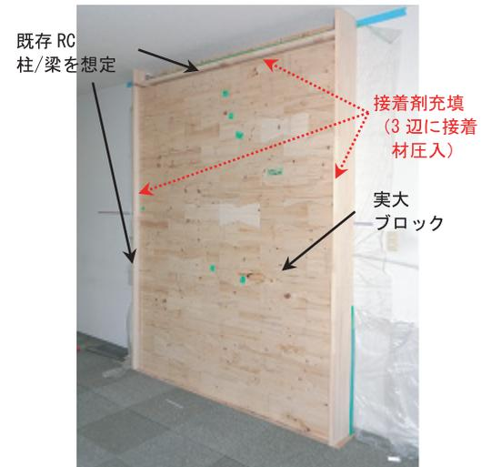
Fig. 13 実大施工試験を実施したモックアップ
