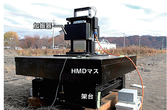
Photo 1 地盤加振用ハイブリッドマスダンパー (HMD) Hybrid mass damper for shaking the ground
