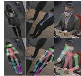
Fig. 5 姿勢推定（人物特徴点検出）の結果 Results of pose estimation (Person feature point detection)
