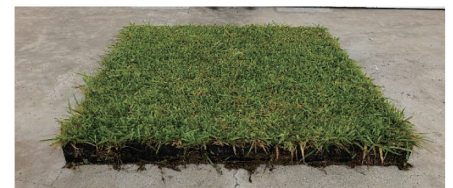
Photo 6.2 芝生・土・保護材のユニット Lawn, soil, and protection units
