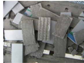
Photo 1 廃タイル裏面の様子 Attaching mortar to old tile
