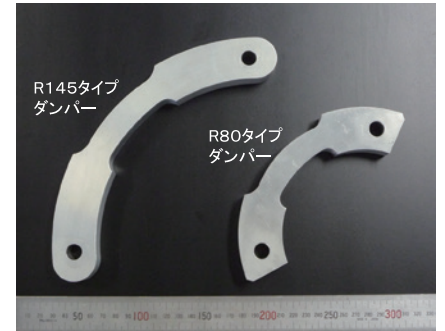
Photo 3 ダンパーの種類 (R145タイプ, R80タイプ) R145 type and R80 type damper
