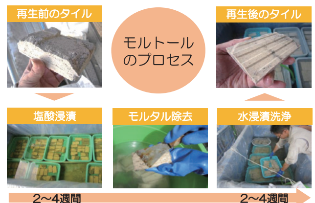
Fig. 2 モルトールのプロセス Process of mortoru
