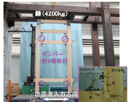
Photo 4 振動実験の試験体（ダンパー4体設置） Wooden frame specimen with dampers
